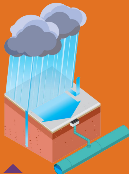
Bij zware regenval kunnen de riolen het water onmogelijk tijdig afvoeren. Dit leidt soms tot wateroverlast.
